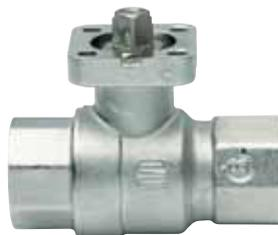
Le valvole **BALL•O•MATIC** hanno il perno di manovra montato dall'interno. Questo sistema è chiamato "antiscoppio" perché offre maggior garanzia contro la fuoriuscita accidentale del perno e del relativo sistema di tenuta. La tripla tenuta sullo stelo è composta da una guarnizione principale in PTFE, un O-Ring ed un anello antifrizione in PTFE.
